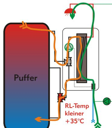
"Duschwasser" (grün), strömt durch den Tauscher zum Abnehmer. Die Pufferpumpe fördert heißes Pufferwasser (orange) im Gegenstrom durch den Wärmetauscher. Die tiefen Pufferrücklaufftemperaturen werden in den unteren Bereich des Puffers geleitet. **WICHTIG:** der untere, kalte Abgang des Ventils ist in der Grundstellung "open". Erst wenn höhere Temperaturen zum Umschaltventil strömen, schaltet das Ventil um.
