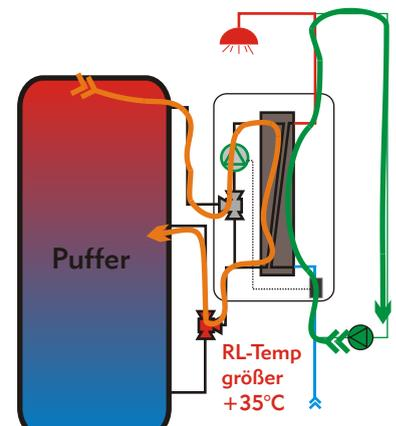
"Zirkulationswasser" (grün), strömt durch den Tauscher zur Nachheizung. Die Pufferpumpe fördert heißes Pufferwasser (orange) im Gegenstrom durch den Wärmetauscher. Die hohen Pufferrücklaufftemperaturen werden von "OptiZirk" in den oberen Bereich des Puffers, in die warme Zone gelenkt.
